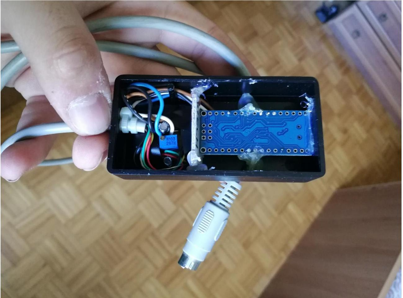
il firmware usato è il classico di K3NG (progetto originale) abbondantemente alleggerito per farlo girare al meglio. Nelle mie prove ho usato un Arduino Nano V3 con un ATmega 168P ma le scarse dimensioni di memoria lo rendono instabile e a giorni passerò ad una versione con ATmega 328P più recente e con prestazioni migliori.
